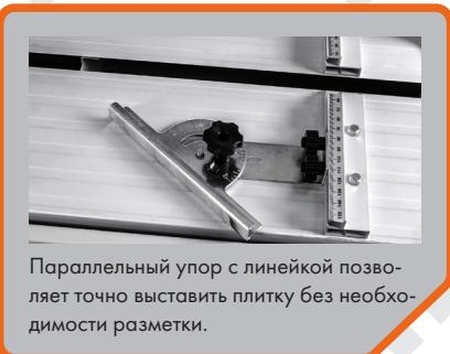
Параллельный упор с линейкой позволяет точно выставить плитку без необходимости разметки.
