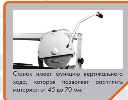
Станок имеет функцию вертикального хода, которая позволяет распилить материал от 45 до 70 мм.
