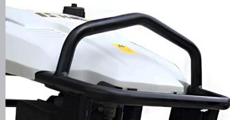
Петля для перемещения грузоподъёмными механизмами.
