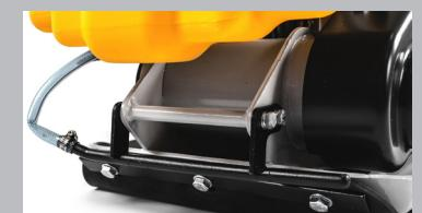
Система орошения предотвратит прилипание основания виброплиты к горячему асфальту.
