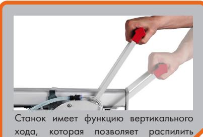
Станок имеет функцию вертикального хода, которая позволяет распилить материал от 30 до 35 мм.
