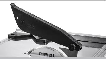
Защитный кожух делает работу оператора более безопасной и предотвращает вылетание мелких частиц.
