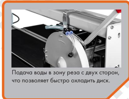
Подача воды в зону реза с двух сторон, что позволяет быстро охладить диск.
