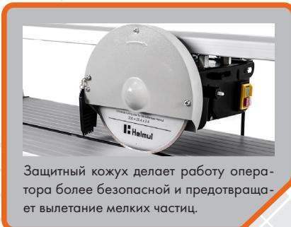
Защитный кожух делает работу оператора более безопасной и предотвращает вылетание мелких частиц.
