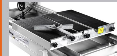
Подкатной столик делает процесс распила для оператора более комфорtnым.
