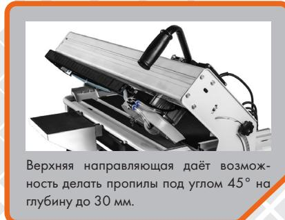
Верхняя направляющая даёт возможность делать пропилы под углом 45° на глубину до 30 мм.
