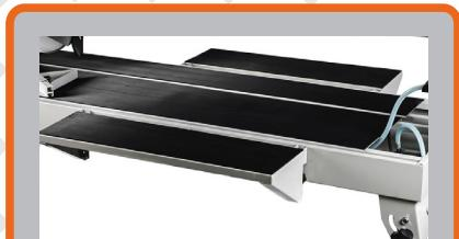
Станок оснащён двумя съёмными столиками, которые в случае необходимости расширяют рабочую поверхность.
